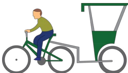
Largo: 2.92 m Ancho: 1.28 m Esquema 43. Bicitaxi
